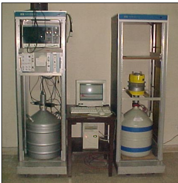
Figura 3: Instrumental para medición de radiación gamma en muestras líquidas.
